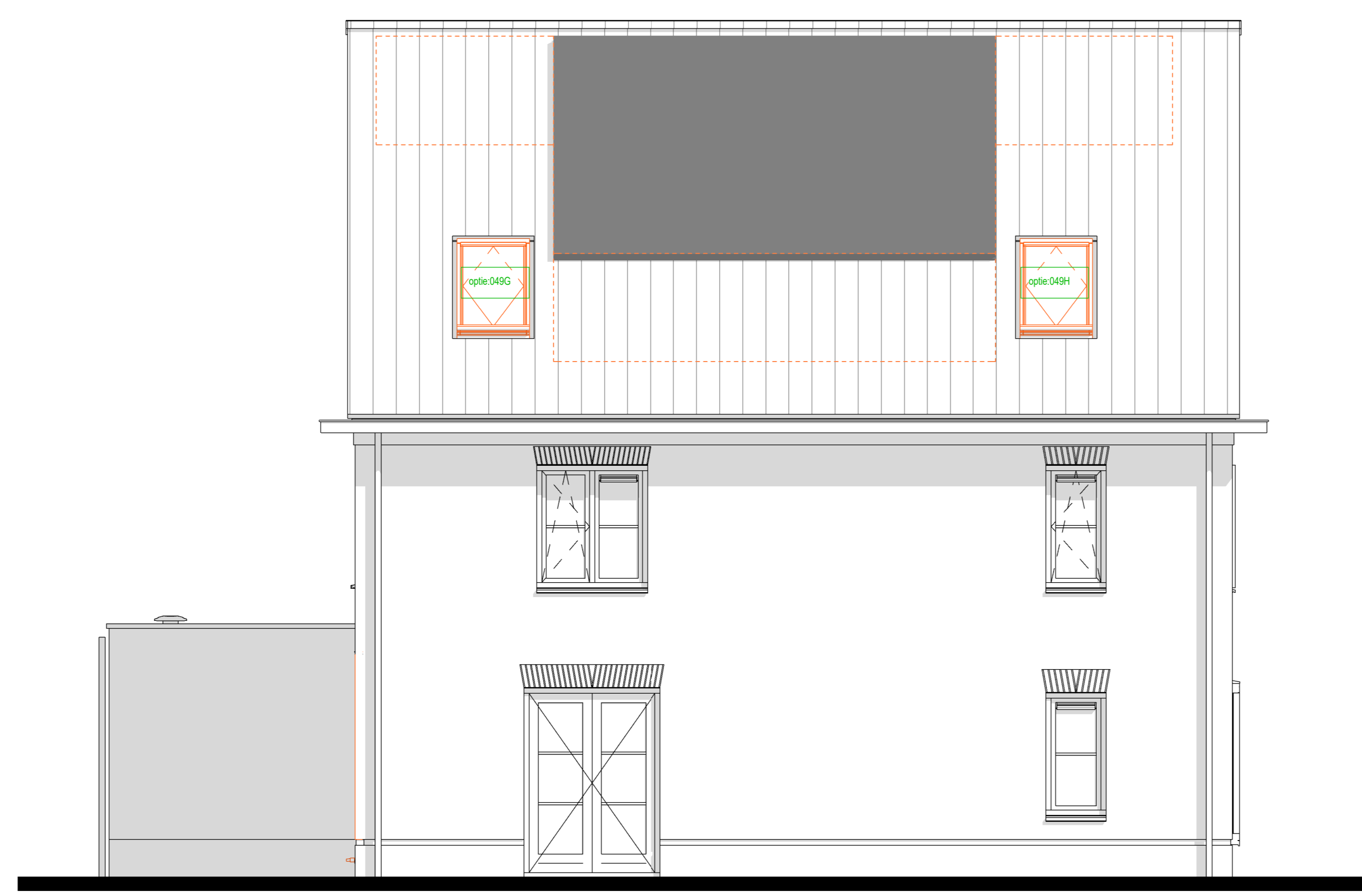
linker zijgevel 011: Dakvel Fako op het zijgevelvlak - paneel 1 012: Dakvel Fako op het zijgevelvlak - paneel 2 024: Extra zonnepanelen
