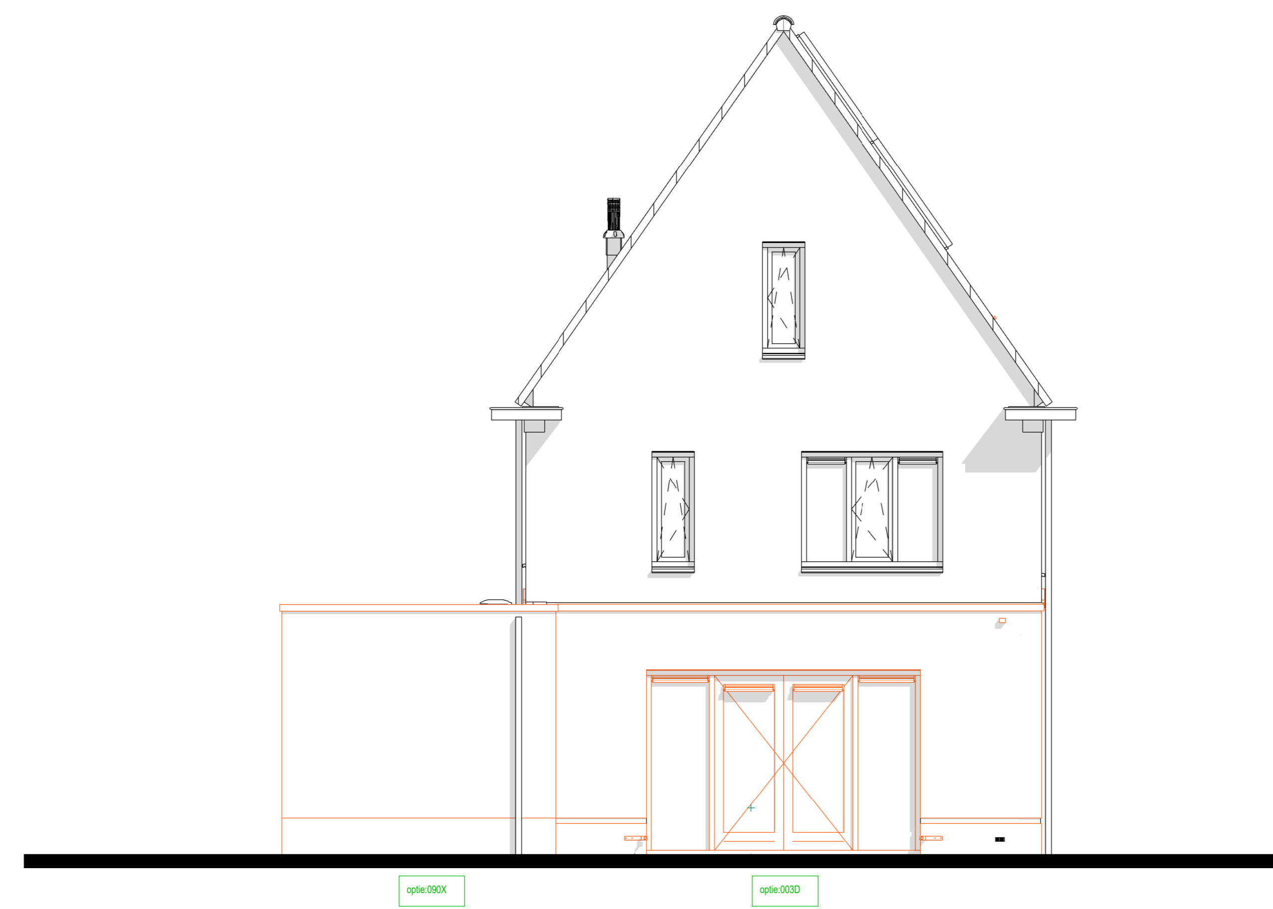
achtergevel 004: Uitbouw achtergevel 2400 mm v.v. dubbele deuren en zijlichten 005: Berging (aantal en positie) berging 1000 mm
