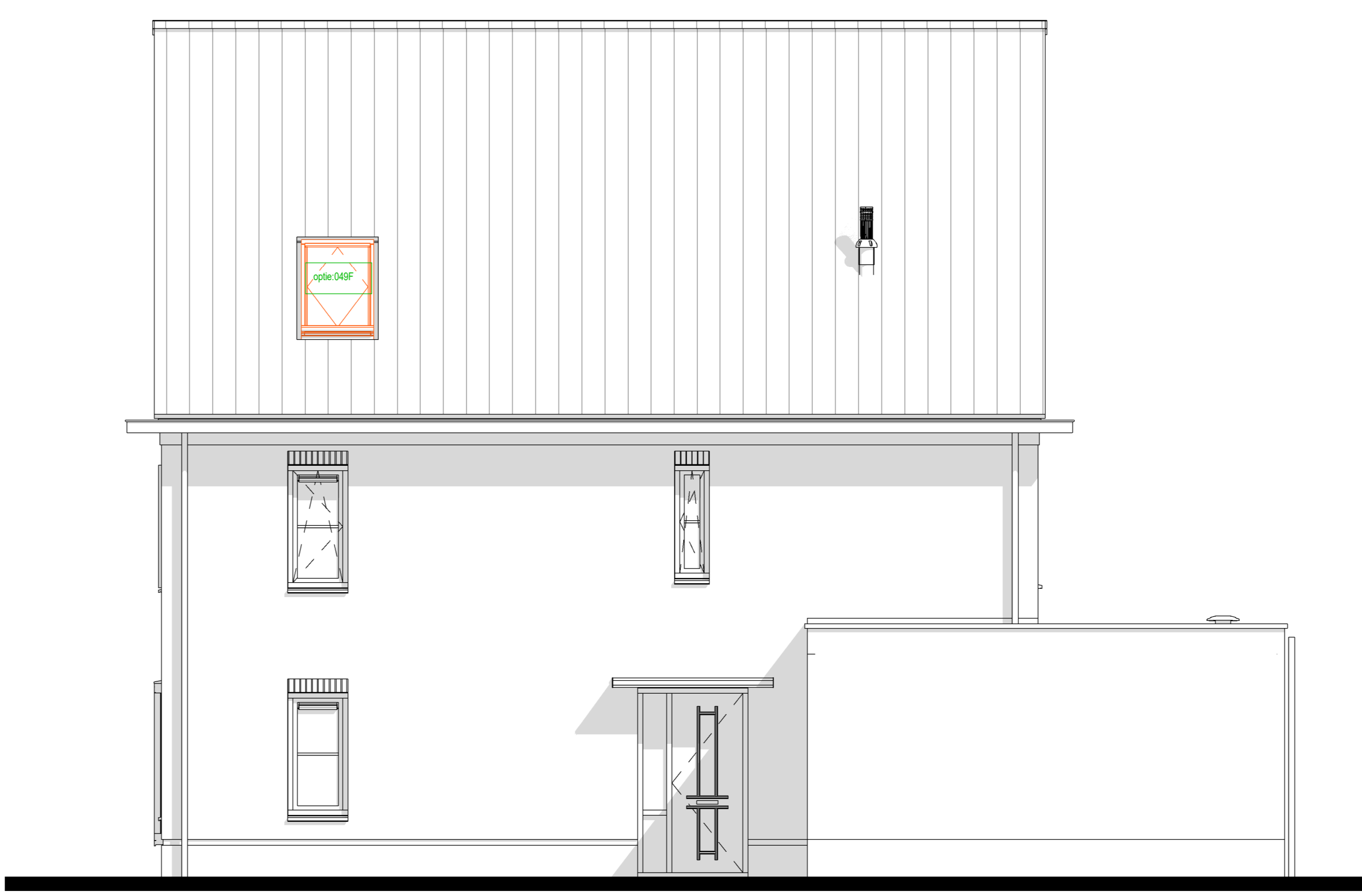
rechter zijgevel 013: Dakvel Fako op het zijgevelvlak - paneel 2
